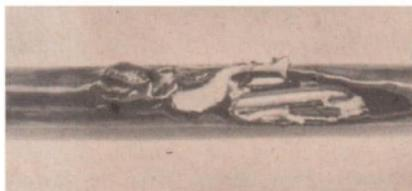
Bild 39/3 Beschädigte Leitung
