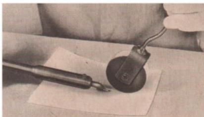
Bild 91/3 Schweißen durch Berührungswärme
