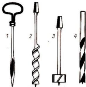
Bild 51/2 Bohrer für die Holzbearbeitung
