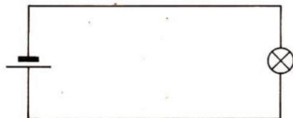
Bild 41/2 Schaltplan des einfachen Stromkreises
