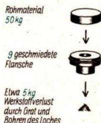
Bild 81/1 Werkstoffeinsparung an einem durch Umformen hergestellten Flansch
