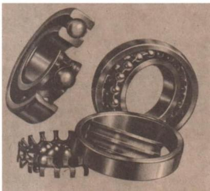
9/3 Aufbau eines Kugellagers
