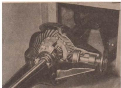
8/2 Achse eines Kraftfahrzeugs
