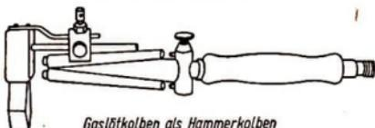
GaslötKolben als HammerKolben
