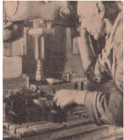
42/1 Säulenbohrmaschine mit Bohrvorrichtung
