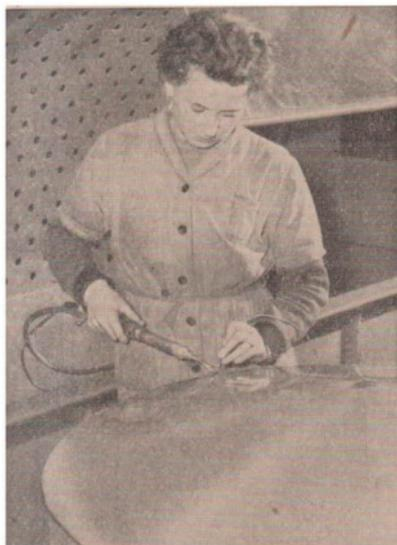
112/2 Schweißen eines Plastbehälters mit dem Heißluft-Schweißbrenner
