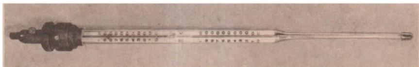
87/2 Kontaktthermometer (VEB Thermometerwerk Geraberg)
