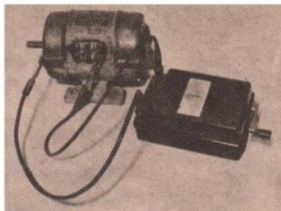
18/4 Prüfen der Wicklungen eines Drehstrommotors auf Körperschluß
