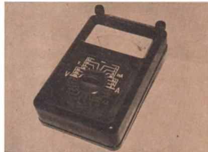
91/3 Vielfachmeßgerät (ältere Bauart)
