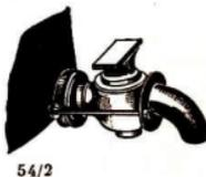
Angewendet für Drücke bis 16 at unter 200°C. Für Nennweiten bis 150 mm. Das Hahnkükten ist kegelig und in das Gehäuse eingeschliffen. Es hat quer zu seiner Längsachse eine runde bzw. ovale Bohrung. Bedienung durch Handgriff oder Hahnschlüssel.
