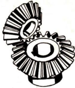
b) Ansicht eines Kegelradgetriebes
