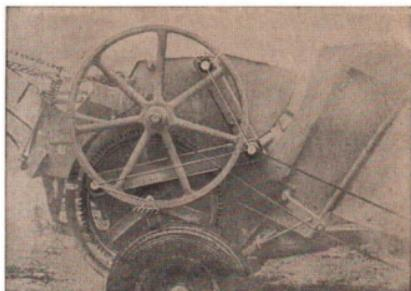
43/1 Kurbelschwinge an der Strohpresse
