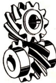
b) Ansicht eines Schraubenrädergetriebes
