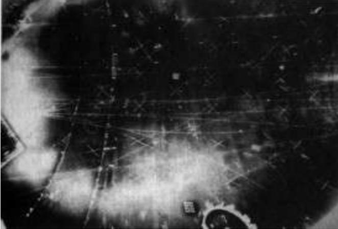
Teilchenspuren in der Wasserstoffblasenkammer BEBC des westeuropäischen Kernforschungszentrums CERN in Genf
