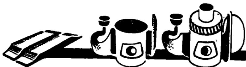
Zufuhr der Aluminiumbarren, Schmelzen, Guß und Abschneiden von Eingußtrichter und Steiger
