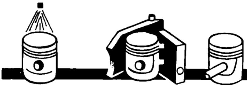
Wieder werden die Kolben gewaschen. Kontrolle der Außenmaße und der Bolzenbohrung. Sortieren nach Größengruppen
