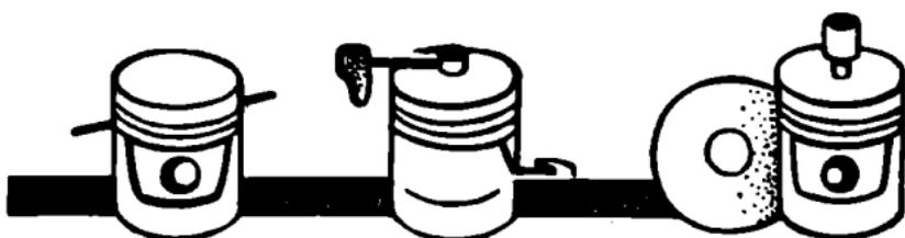
Die Öllöcher werden gebohrt. Schlichten. Fräsen des schrägen Ölschlitzes. Abstechen des Zentrierzapfens
