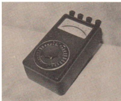
87/1 Vielfachmeßgerät (ältere Bauart)
