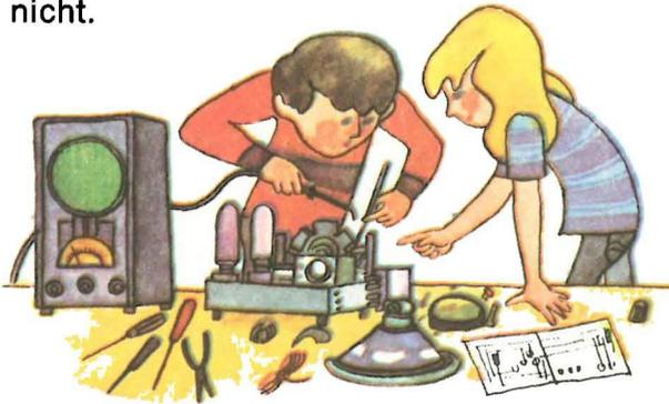
Das Löten mit einer Zinnlegierung wird *Weichlöten* genannt, im Gegensatz zum *Hartlöten*, für das als Lot Legierungen von Kupfer und Zink (Messinglot) oder mit Silberzusatz (Silberlot) – beide für Schwermetalle – und Legierungen aus Aluminium und Silizium (Aluminiumlot) oder aus Zink, Aluminium und Kadmium – für Leichtmetalle – dienen.
