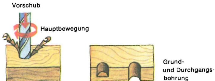
Die kreisrunden Löcher, die Bohrungen, führen entweder ganz durch das Werkstück oder nur ein Stück hinein. Deshalb unterscheiden wir *Durchgangsbohrungen* und *Grundbohrungen*.
