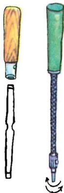
Der *Drillschraubenzieher* nimmt uns das beschwerliche Drehen ab, denn durch senkrecht Drücken des Heftes drehen sich Spindel und Klinge und kehren beim Nachlassen automatisch in die Ausgangsstellung zurück. Ein weiterer Vorteil: Es lassen sich Klingen unterschiedlicher Größe einsetzen.
