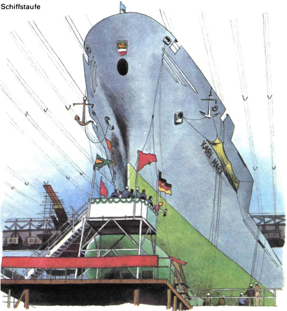
Vor wenigen Wochen war auf der → Helling das Schiff auf Kiel gelegt worden. Krane haben die einzelnen Unterteile des Schiffs auf vorbereitete hölzerne Stapel gehoben, die den hochwachsenden Schiffskörper trugen und seitwärts stützten.
