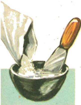
man dem Gipsstein mit Hilfe verschiedener Brenntemperaturen ganz oder teilweise das Kristallwasser (chemisch gebundenes Wasser). Später, beim Anrühren, kehrt sich der Vorgang gleichsam um: Der Gips erhärtet durch die Wasseraufnahme.
