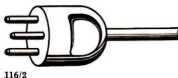
Schutzkleinspannung wird immer dort angewendet, wo recht beengte Arbeitsverhältnisse vorliegen, bei denen der Mensch sehr nahe gut elektrisch leitenden Werkstoffen und dem elektrischen Strom ist. Das trifft zu bei Arbeiten in Behältern (z. B. Kessel), in und an Backöfen und in Rohrleitungssystemen.
