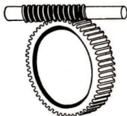
Die Zähne des einen Rades (Schnecke) sind so schräg angeordnet, daß sie wie ein Gewinde einer Schraube umlaufen; so Verwendung für sich kreuzende Achsen möglich.
