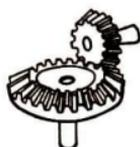
Die Zähne der Räder zweier sich schneidender Achsen greifen formschlüssig ineinander. Zähne sind auf Kegelmantelflächen angeordnet; Achswinkel zwischen  $0^\circ$  und  $180^\circ$  sind möglich.
