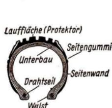
Bild 16 Schnitt durch eine Decke
