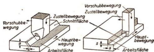
Bild 2 Hauptbewegung und Nebenbewegungen der Hobelmaschine
