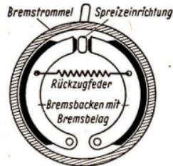
Bild 22 Prinzip einer Innenbackenbremse
