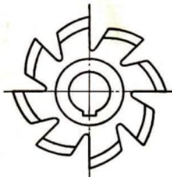
Bild 8 Fräser mit hinterdrehten Zähnen
