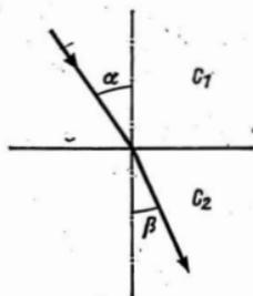
In Tabellenbüchern gibt man nicht die Ausbreitungsgeschwindigkeiten  $c$ , sondern die dimensionslosen optischen Stoffkonstanten  $n$  an. Diese werden als absolute Brechungszahlen bezeichnet.
