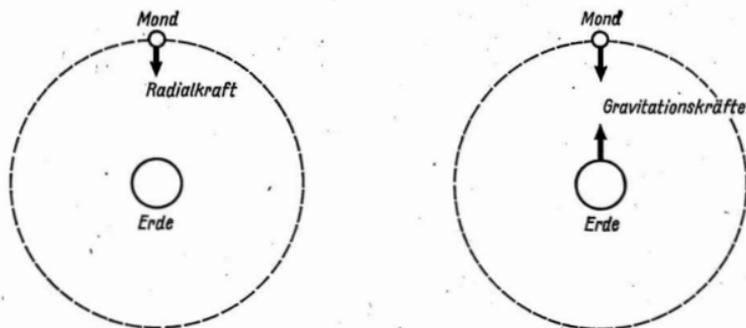
(2b) Eine Kreisbewegung wird durch eine Radialkraft hervorgerufen.
