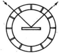
(1b) Trifft Licht auf Körper, so wird ein Teil des Lichtes in eine neue Richtung gelenkt.
