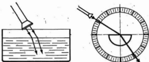
(1b) Trifft Licht aus der Luft auf die Grenzfläche von Wasser oder Glas, so geht der größte Teil des Lichtes in das Wasser oder Glas über. Dabei wird die Richtung des Lichtes verändert.
