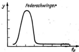
Wenn diese Messungen mit anderen Schwingern wiederholt und die Meßwerte jeweils grafisch dargestellt werden, ergeben sich immer wieder Kurven mit der gleichen typischen Form. Die Amplitude der erzwungenen Schwingung ist am größten, wenn die Erregerfrequenz mit der Eigenfrequenz übereinstimmt. Man spricht dann von Resonanz zwischen dem anregenden Körper und dem angeregten Körper. Die Kurve nennt man Resonanzkurve.
