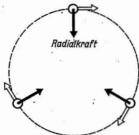
(2b) Jede auf einen Körper wirkende Kraft erteilt diesem eine Beschleunigung. Diese kann in einer Änderung des Betrages oder der Richtung der Geschwindigkeit bestehen. Die Bewegung eines Massenpunktes auf einer Kreisbahn ist eine beschleunigte Bewegung, denn es wird ständig die Richtung der Bewegung und damit auch die Richtung der Geschwindigkeit geändert.
