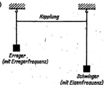
(2b) Wird einem schwingungsfähigen Körper kurzzeitig Energie zugeführt, kann der Körper eine Schwingung mit seiner Eigenfrequenz ausführen. Erfolgt die Energieübertragung periodisch durch einen anderen schwingenden Körper, so führt der angeregte Körper eine erzwungene Schwingung mit der Erregerfrequenz aus.
