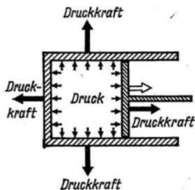
(2b) Der Druck eines Gases gibt an, wie stark das Bestreben des Gases ist, sich auszudehnen.
