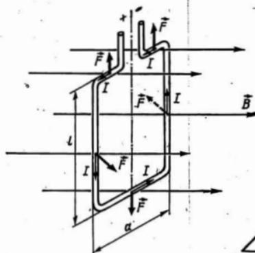
Auf die beiden Seiten  $I$  wirken entgegengesetzt parallel gerichtete Kräfte, die die Spule drehen. Die Drehung erfolgt gegen die Gegenkraft von Spiralfedern. Auf die beiden Seiten  $a$  wirken entgegengesetzt parallel gerichtete Kräfte, sie versuchen, die Spule zu strecken.
