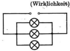
(1b) Bei der Parallelschaltung von elektrischen Geräten verzweigt sich der elektrische Strom.
