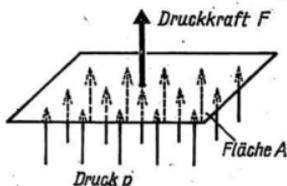
Je größer der Druck ist, desto größer ist die auf eine bestimmte Fläche wirkende Druckkraft.
