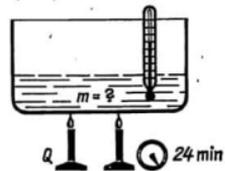
4. Im Versuch a wird die Temperatur von 200 g Öl um 30 K erhöht. Welche Temperaturerhöhung wird in den Versuchen b und c erreicht ?
