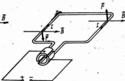
Hätte der Strom immer die gleiche Richtung, so würde sich die Spule nicht weiterdrehen, sie würde eine Gleichgewichtslage einnehmen. Der Motor braucht eine Vorrichtung zum Umpolen der Stromrichtung nach jeweils einer halben Umdrehung (Kommutator).
