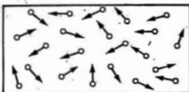
(2d) Der Druck eines Gases gegen die Begrenzungsflächen entsteht durch die Stöße der Gasmoleküle gegen die Begrenzung.
