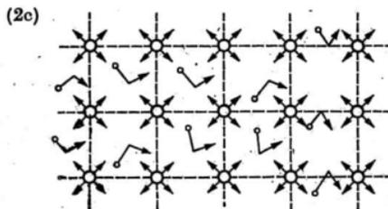
(2d) Durch die ständigen Zusammenstöße der Elektronen mit den Ionen im Metallkristall wird die gerichtete Bewegung der Elektronen behindert. Je größer diese Behinderung der Bewegung der Elektronen ist, desto größer ist der elektrische Widerstand eines Leiters.
