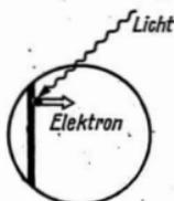
(2b) Bei der Bestrahlung einer Photozelle mit Licht werden Elektronen aus dem Metall herausgelöst. Verwendet man nacheinander verschiedenfarbiges Licht, so ist die Energie der herausgelösten Elektronen verschieden.
