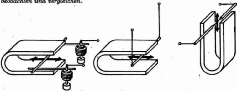
(1b) In magnetischen Feldern wirken auf stromdurchflossene Leiter unterschiedliche Kräfte.
