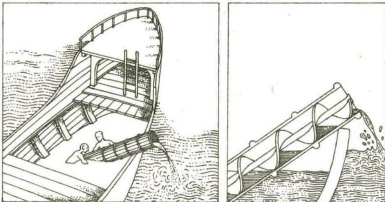
Von Archimedes konstruierte wasserschöpfende Spirale
