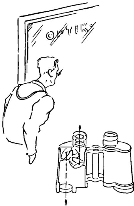
Daher wohl der Name. Ja — wenn man die beiden eingezeichneten Strahlen verfolgt, dann sieht man auch, wie hier die Lichtstrahlen umgekehrt werden. Prisma 1 vertauscht oben und unten, Prisma 2 rechts und links.
