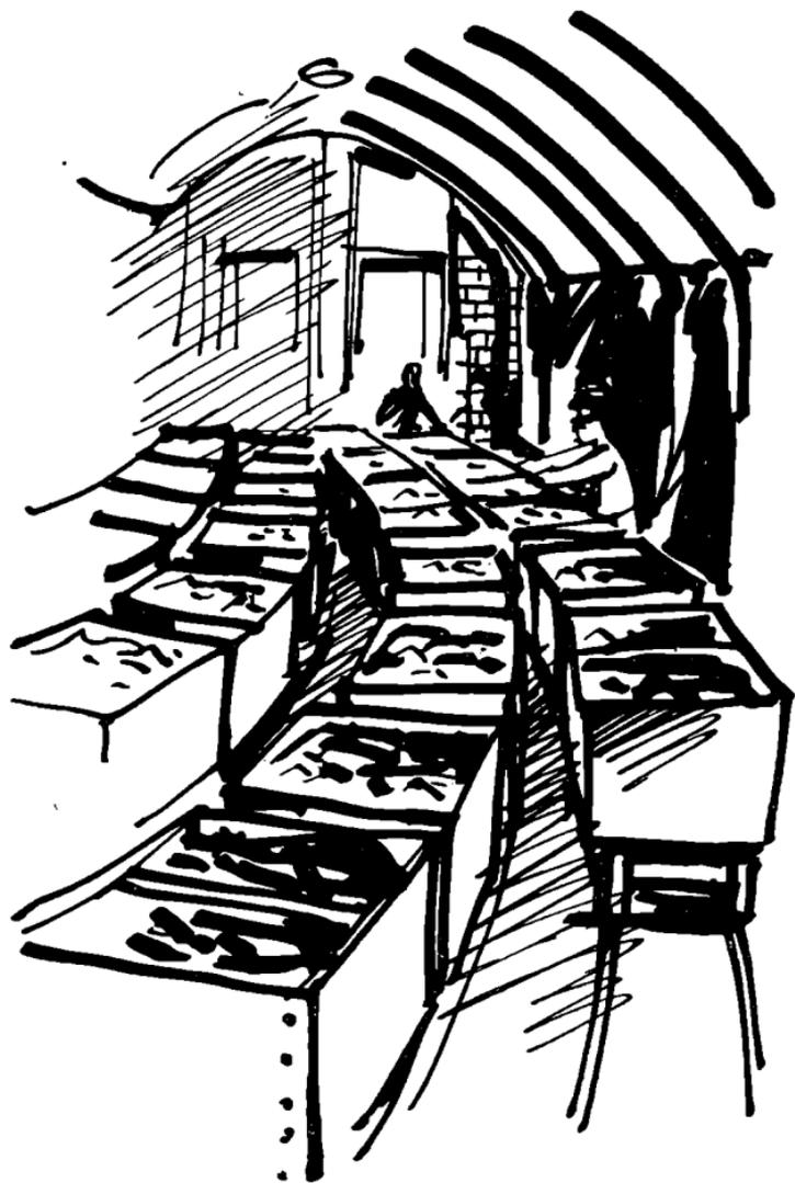
Hängebank. Von Akkumulatoren gespeiste Elektroloks ratterten heran und schlepten die gefüllten Hunde hinter sich her. Wir glaubten uns auf einen Verschiebebahnhof der Reichsbahn versetzt. Loks rangierten, Wagen wurden in die Fördereinrichtung geschoben, neue Züge tauchten von fern aus dem Dunkel auf. Füllort heißt in der Sprache des Bergmanns ein solcher Umschlagplatz unter Tage am Schachtloch.
