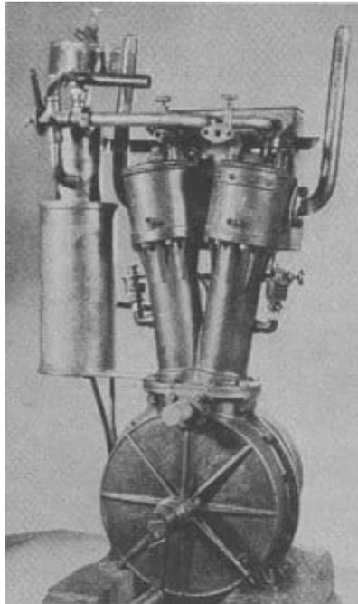
11 Der Zweizylinder-V-Motor (1889) mit vollständig gekapseltem Kurbelgehäuse, dem (links sichtbaren) Oberflächenvergaser und dem hinter beiden Zylinderköpfen erkennbaren Gehäuse für die Glührohrzündung
