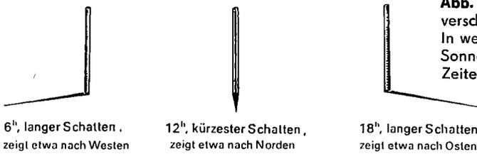
**Abb. 4** Ein Schattenstab zu verschiedenen Tageszeiten. – In welcher Richtung steht die Sonne zu den angegebenen Zeiten?
