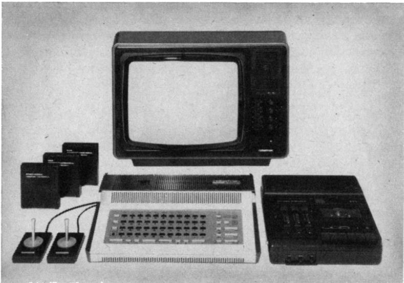
Bild 7.1.1. Minimalkonfiguration des KC 85/1 ergänzt durch zwei Spielhebel
