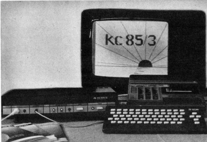
Bild 7.3.1. Der KC 85/3 in der Minimalkonfiguration
