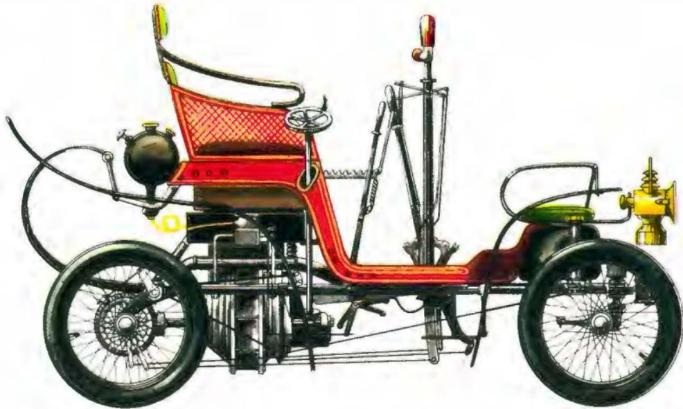
Automobilbauer nicht. Die große Zuverlässigkeit und Einfachheit der Dampfmaschine, ihr geräuschloser und elastischer Lauf, die geringe Drehzahl mit niedrigem Verschleiß, die hohe Belastbarkeit und die Fähigkeit, unter Last anzufahren, ohne ein Getriebe zu benötigen, lockten Unermüdliche immer wieder zu neuen Experimenten.
