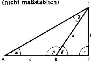
Man steckt eine Standlinie  $\overline{AB}$  so ab, daß  $A$ ,  $B$  und  $F$  auf einer Geraden liegen, und mißt die Erhebungswinkel  $\sphericalangle BAC$  und  $\sphericalangle FBC$  (siehe Skizze!).
