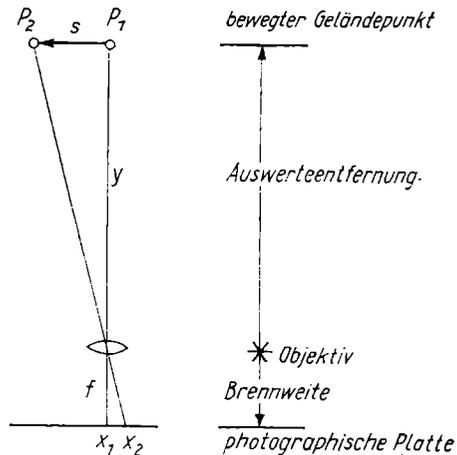
Prinzip der Geschwindigkeitsmessung an Gletschern
