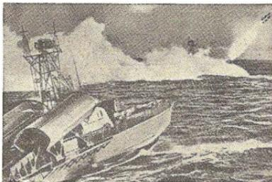
**Sowjetisches Schnellboot mit zwei Raketen-Abschurampen an Deck im Angriff. Im Hintergrund eines der Boote beim Abfeuern einer Rakete.**
