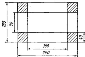
Zur Herstellung des Kastens werden 296 cm<sup>2</sup> Zinkblech benötigt; er faßt 448 cm<sup>3</sup>, das sind 0,448 l Flüssigkeit.
