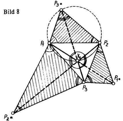
Im 2. und 3. Fall soll weiterhin das  $\Delta P_1P_2P_3^*$  mit  $\overline{P_1P_2} = l_3$ ,  $\overline{P_1P_3^*} = l_2$  und  $\overline{P_2P_3^*} = l_1$  existieren, aber es sollen nicht alle drei Ungleichungen  $\alpha_1 + \beta_1 < 180^\circ$ ,  $\alpha_2 + \beta_2 < 180^\circ$  und  $\alpha_3 + \beta_3 < 180^\circ$  gelten.
