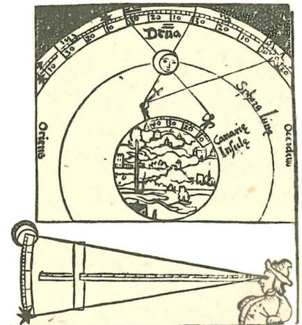
Bestimmung der geographischen Länge durch Messung von Mondabständen mittels Jakobsstab
