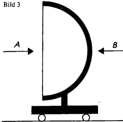
Auf einem Wagen sei eine halbe Hohlkugel angebracht. Der Wagen läßt sich (wie eine Modelleisenbahn-Lokomotive) mit einem Elektromotor antreiben. Die Motorleistung kann von außen geregelt werden. Der Versuchswagen befindet sich in einem Windkanal. Die Hohlkugel soll zum einen aus Richtung A und zum anderen aus Richtung B angeblasen werden.
