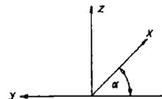
Da der Betrachter meist eine Zeichnung senkrecht zur Blickrichtung hält, erscheinen orthogonalaxonometrische Bilder weniger verzerrt als schiefaxonometrische. Sehr gebräuchliche orthogonale Axonometrien, die Dimetric und Isometrie, sind durch folgende Angaben bestimmt:
