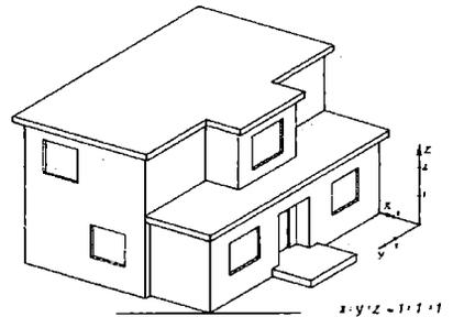
Das Verhältnis  $x:y:z = 1:1:1$  bedeutet, auf allen drei Achsen sind gleiche Längeneinheiten gewählt worden. In der Praxis werden oft die beiden schiefen Axonometrien, Militärperspektive und Kavaliersperspektive, verwendet. Für sie gilt:
