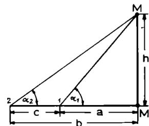
▲ 4 ▲ In dieser Form aufgemessene Grundstücke werden in Dreiecke und Trapeze zerlegt.
