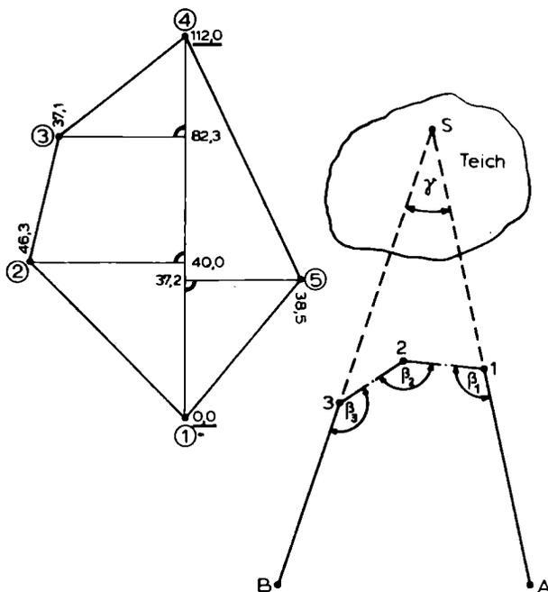
▲ 5 ▲ Es sind 2 Gleisachsen gegeben:  $A-1$  und  $B-3$ . Diese sollen mit einer Kurve verbunden werden.
