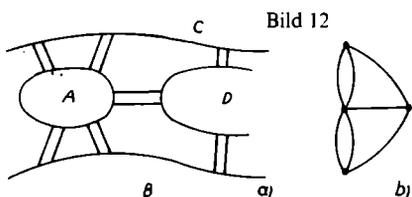
Dem Bild 12a können wir den Graphen des Bildes 12b zuordnen. Seine Knotenpunkte stellen die Festlandteile *A, B, C, D* dar. Zwei Knotenpunkte sollen durch soviel Kanten verbunden werden, wie die ihnen entsprechenden Festlandteile durch Brücken verbunden sind.
