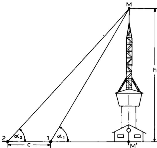
Hierbei liegen  $M'$ , 1 und 2 auf einer Geraden und in gleicher Höhe. Wie hoch ist die Höhe  $h$  des Turmes?
