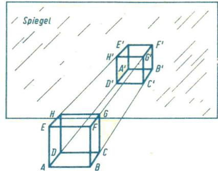
Bild 3: Gegenstand und Bild in Zentralprojektion
