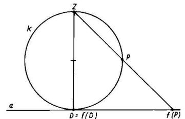
Als Projektionszentrum dient bei der stereographischen Projektion ein beliebiger Punkt Z der abzubildenden Kugeloberfläche K, als Bildebene e die Tangentialebene an K im zu Z diametralen Punkt D der Kugel. Jedem von Z verschiedenen Punkt P von K wird der Schnittpunkt der Geraden PZ mit der Bildebene e als Bildpunkt  $f(Z)$  zugeordnet. Nur Z selbst hat keinen Bildpunkt. Genau die Kreise der Kugeloberfläche, die durch Z verlaufen, werden in Geraden von e abgebildet. Warum?
