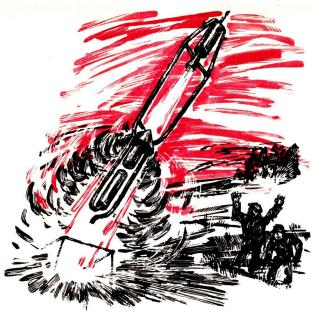
stoff – Benzin und flüssigen Sauerstoff – vom Tank unten in den Raketenmotor nach oben leitete. Das ganze Gerät besaß eine Länge von 3 m und stand senkrecht in seinem Abschußgestell. Das war "Nelly" oder "Nell", wie die Flüssigkeitsrakete kurz und zärtlich von den Mitgliedern des Familienteams genannt wurde. Durch dreijährige gemeinsame Versuche waren die Familienmitglieder gut aufeinander eingespielt.
