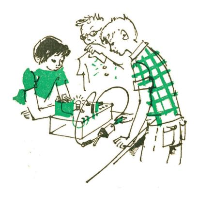
Kondensator an, so blitzt die Lampe wieder auf. Die Ladung, die im Kondensator gespeichert war, hat sich in Licht und Wärme umgewandelt.
