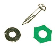
terlegscheiben verwendet man beispielsweise in vielen Maschinen und Geräten. Zu ihrer Herstellung dienen Werkzeugmaschinen, die die Teile selbsttätig fertigen. Nur so ist es möglich, große Mengen von Maschinenelementen mit geringem Aufwand herzustellen.
