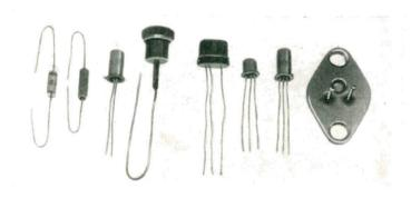
14 Dioden (links) und Transistoren (rechts)
