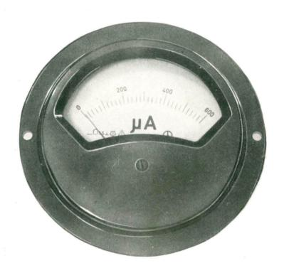
11 Strommesser mit einem Endausschlag von 600  $\mu A$  (=0,6 mA)
