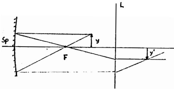
Das reelle Bild entsteht innerhalb der einfachen Brennweite vor der Linse.
