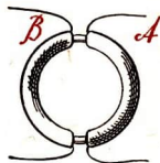
Der erste Umspanner der Welt, nach einer Originalzeichnung von Faraday
