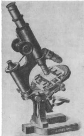
29 Großes Hufeisenstativ I a mit beweglichem Objektisch [21, Nr. 28, 1889, Ss. 31]
