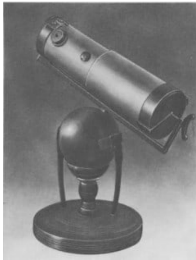
5 Newtons zweites Spiegelteleskop
