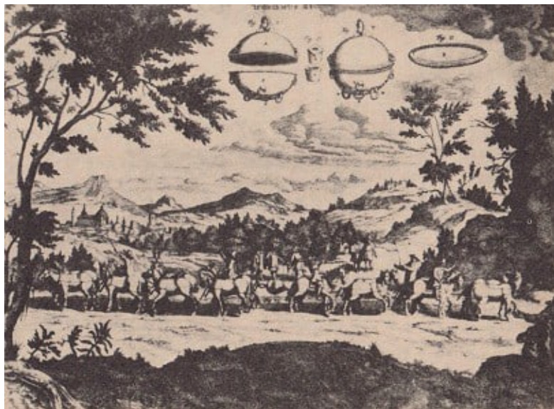
Abb. 6. Der berühmte Versuch mit den Magdeburger Halbkugeln
