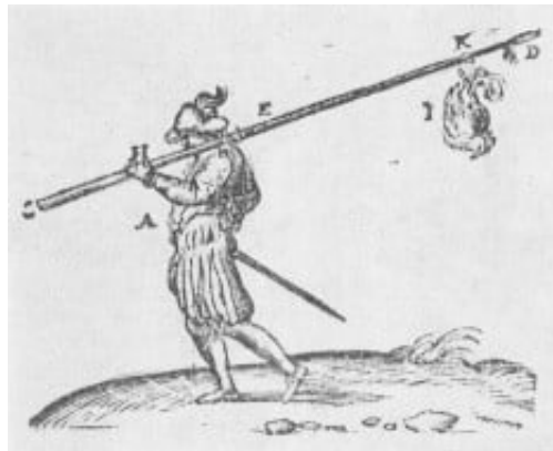
11 Beispiel Stevins zum ungleicharmigen Hebel. Zu bestimmen ist die zum Gleichgewicht notwendige Kraft, die bei H angreift [8]
