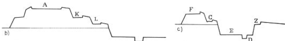
27 b) Schnitt durch die Mitte einer Bastion A . K und L sind Orillons (Feuerstellungen zur Flankendeckung) [12]
