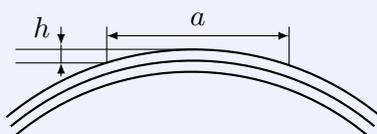
Eine große Trockentrommel wird aus gewölbten Blechen zusammenschweißt. Durch einen Messschieber werden folgende Maße ermittelt:  $a = 400$  mm,  $h = 10$  mm.
