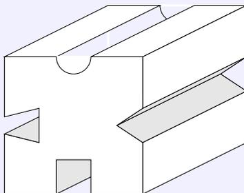
Aus einem Rundeisen von 101 mm Durchmesser wird ein gleichlange Vierkantstab geschmiedet. Dabei bleibt der Rauminhalt des Werkstücks unverändert. Parallel zu den Längskanten wird je eine Nut eingefräst.
