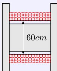
Auf einer Kabeltrommel sind drei Lagen eines Starkstromkabels aufgewickelt. In jeder Lage befinden sich 15 Windungen des Kabels, das einen Durchmesser von 4 cm hat.
