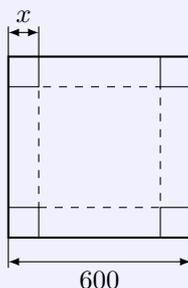
Aus einem quadratischen Stück Blech mit der Kante  $a = 600$  mm werden an den Ecken Quadrate mit der Seite  $x$  herausgeschnitten.
