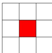
Die Abbildung zeigt einen möglichen Zuschnitt für den Mantel des gewünschten Behälters. Die genutzte Fläche beträgt  $5 \cdot 100 \text{ cm}^2$ , der Abfall  $4 \cdot 100 \text{ cm}^2$ .
