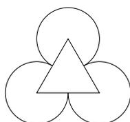
Entsprechend der Hilfszeichnung besteht die Figur des Querschnittes aus einem gleichseitigen Dreieck (Seitenlänge  $2r$ ) und 3 Kreissektoren mit dem Zentriwinkel  $300^\circ$ . Somit ist die Fläche:
