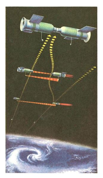
Mit Hilfe von Radarsignalen – auf dem Bild gelb-rot dargestellt – wurden die Satelliten "Kosmos 186" und "Kosmos 188" automatisch gekoppelt
