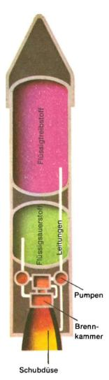
Schema einer Rakete mit flüssigem Treibstoff
