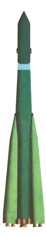
Sowjetische Trägerrakete, deren Antriebsstufen gebündelt angeordnet sind
