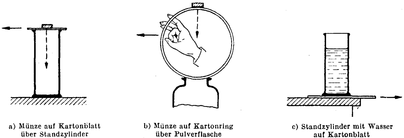
Abb. 52 Trägheit beim Fortziehen der Unterlage
