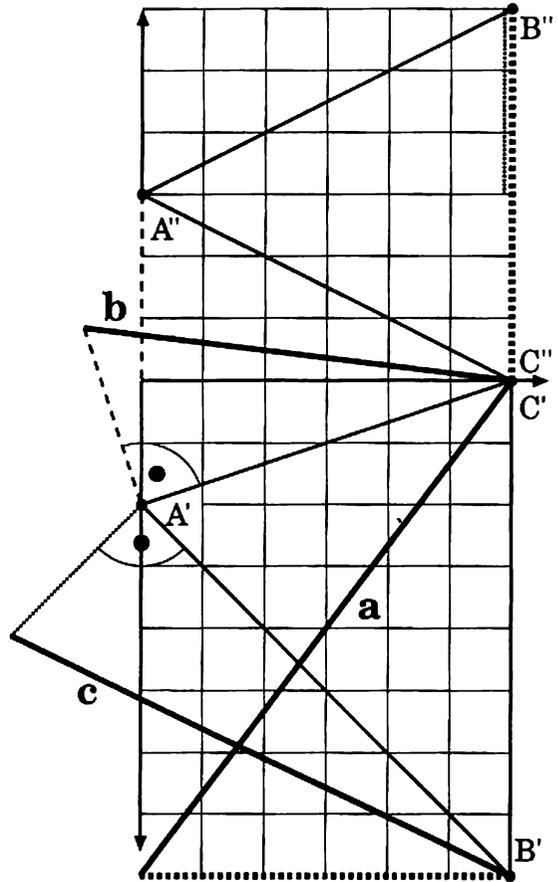
Die Seitenlängen  $a, b$  und  $c$  sind mit Stützdreiecken konstruiert. Die Winkel findet man im Dreieck mit den Seiten  $a, b$  und  $c$ .
