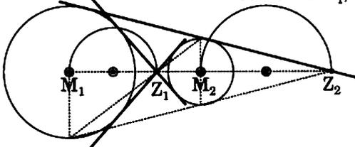
Tangenten: Taleskreise über  $M_1Z_1$  und  $M_2Z_2$  eine Tangente ist nicht eingezeichnet, sie würde sonst die Konstruktion verdecken.
