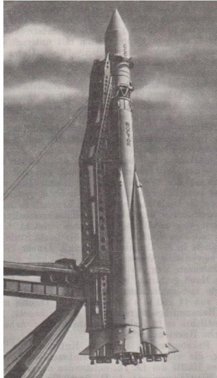
Abb. 3. „Wostok“ - eine sowjetische dreistufige Trägerrakete, vielfach eingesetzt, um bemannte Raumflugkörper unterschiedlicher Zweckbestimmung in den Weltraum zu tragen. Diese Rakete brachte am 12.4.1961 den ersten bemannten Raumflugkörper der Welt mit dem Fliegerkosmonauten J. A. Gagarin als Piloten auf die Umlaufbahn
