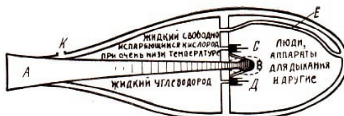
Abb. 31. Ziolkowskis Rakete von 1915, Zeichnung von K. E. Ziolkowski Inschrift links oben: flüssiger, frei verdunstender Sauerstoff bei sehr niedriger Temperatur; links unten: flüssiger Kohlenwasserstoff; rechts: Menschen, Apparate für die Atmung und anderes
