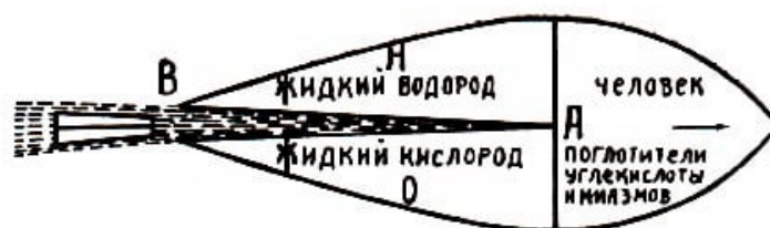
Abb. 29. Ziolkowskis Raketenprojekt von 1903 (mit gerader Düse). Zeichnung von K. E. Ziolkowski,
